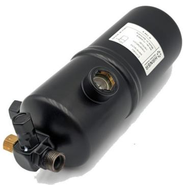
SammlerTrockner 0,8 Liter Volumen, 223mm Stahl mit Schauglas u. Indikator und Sicherheitsventil 40 bar
