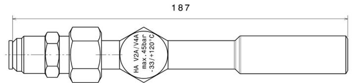
HANSA Wechselventil 45bar
