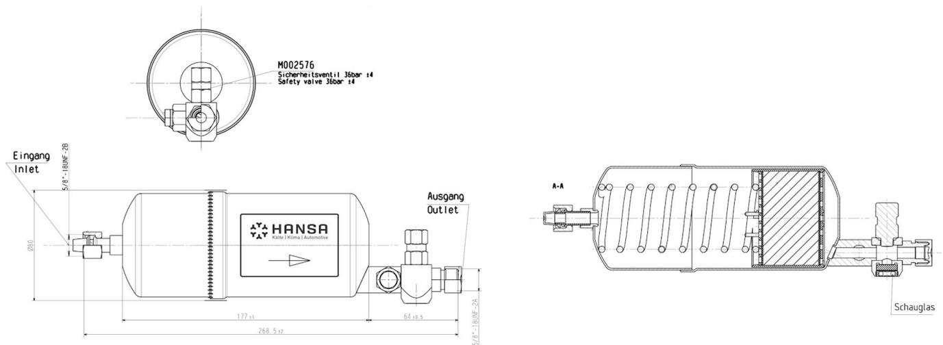
HANSA 2525535050 mit Druckschalter / with pressure switch
